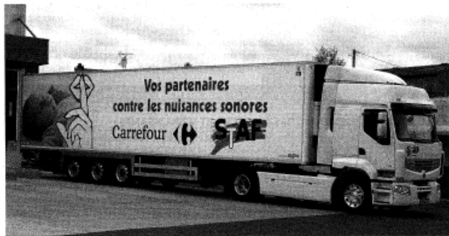
La STAF a adopté la norme Piek pour ses véhicules. Résultat : moins de 60 décibels émis.
